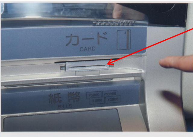
スキマーの取付状況
